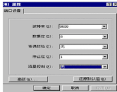
图 5.3 设置超级终端时的串口参数
