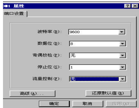
图 5.3 设置超级终端时的串口参数
